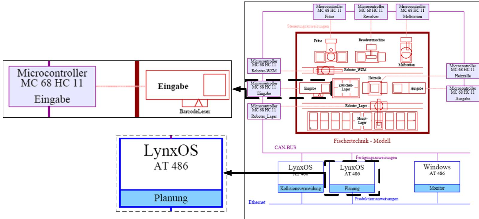
Verteiltes System zur Steuerung der Industrieanlage ⇒ **Prozesse (tasks)**
