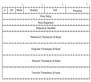
Genauere Informationen bezüglich des Aufbaus einer SNTP Message finden Sie unter http://www.networksorcery.com/enp/protocol/sntp.htm. Zum Versenden der SNTP Nachricht müssen folgende Felder gesetzt werden:
