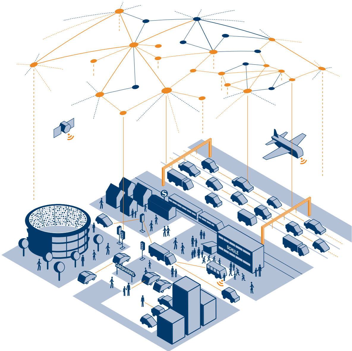
Abbildung 2.2: Vernetzte Komponenten und Beteiligte der umfassenden Mobilitätsassistenz und ihre situationspezifische Koordination, symbolisiert durch direkte Verbindungen zwischen Beteiligten und mit global vernetzten CPS-Diensten
