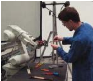
Monteur und Roboter bilden ein Team. Dazu teilen und koordinieren sie die Aufgaben. Aufgrund seiner kognitiven Fähigkeiten weiß ein Roboter, was er in welcher Situation zu tun hat: Er nimmt die Umgebung mit Sensoren wahr, zieht Schlüsse und lernt Bild: IWB
